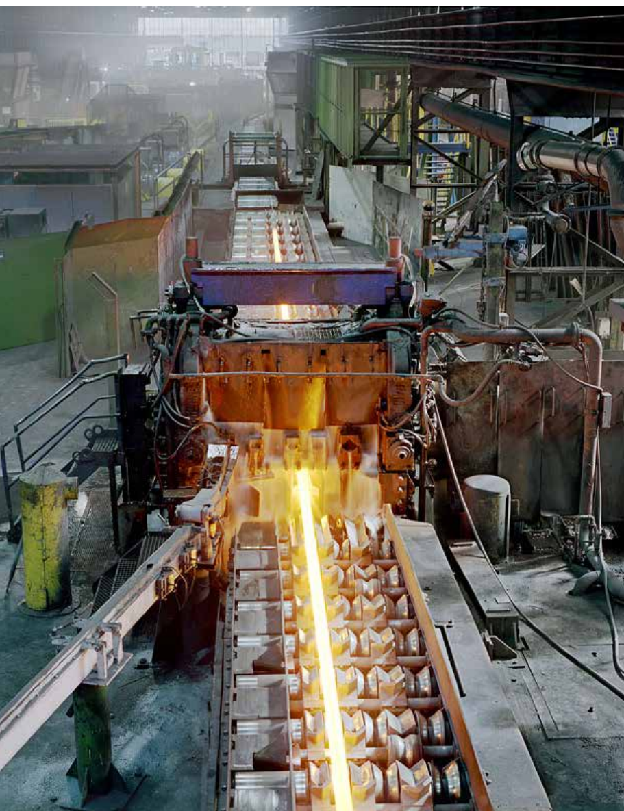
Trio-Vorgerüst. Foto: Uwe Niggemeier
