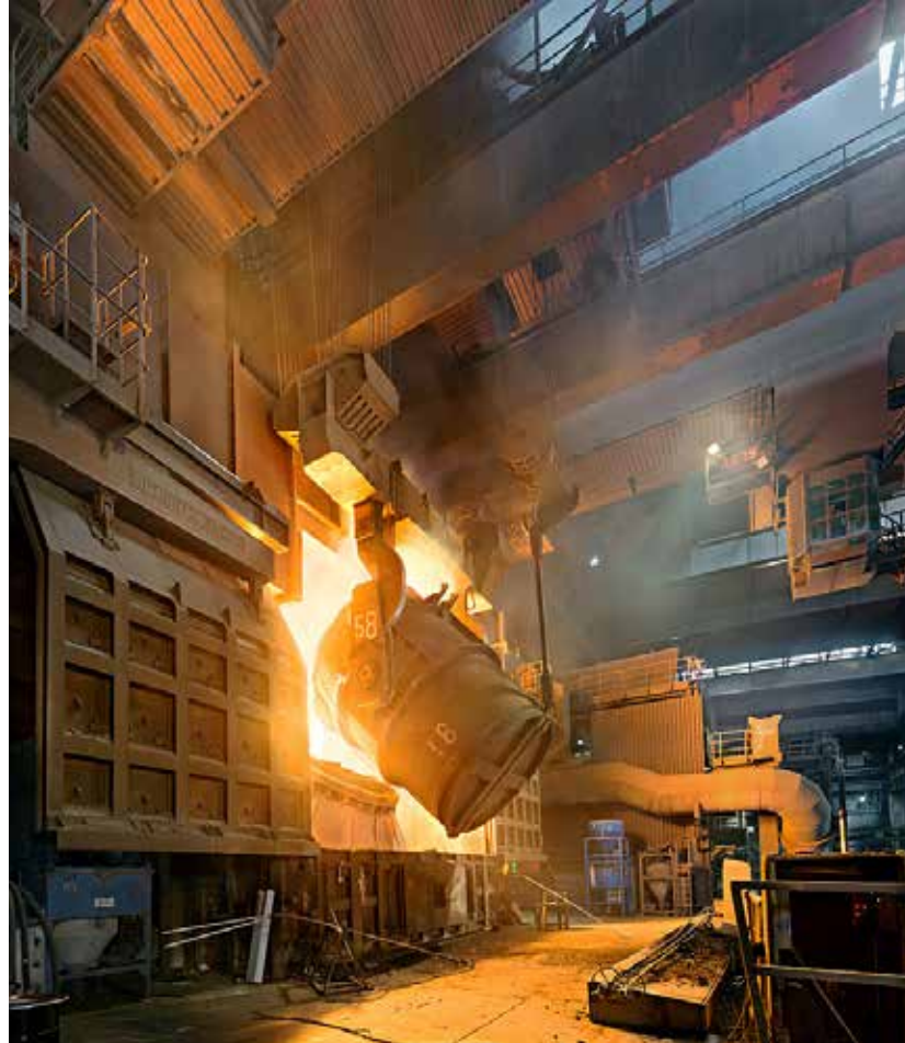
Konverterbefüllung im Stahlwerk Beeckerwerth. Foto: Uwe Niggemeier
